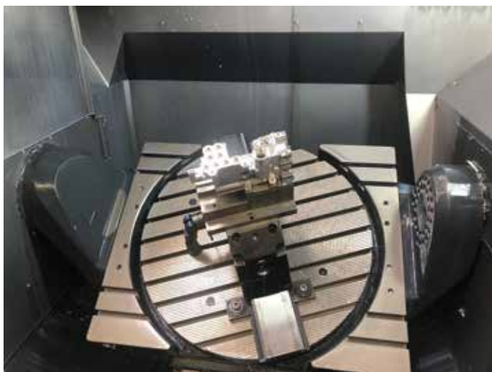
Hydraulikblock im Arbeitsraum der 5Achs-Maschine.
